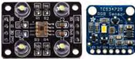
Figura 3.3.1. Sensores de color. A la izquierda TCS3200, a la derecha TCS34725.
