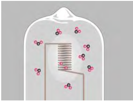
Figura 3.1.7. Los halógenos se combinan con las moléculas de tungsteno, formando halogenuros de tungsteno.
