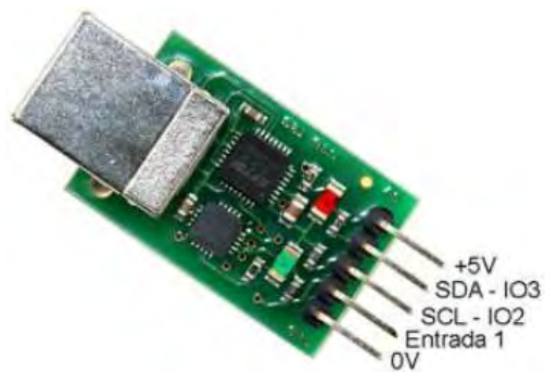
Figura 3.3.26. Ubicación terminales en el módulo USB - I2C.
