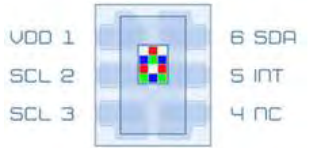
Figura 3.3.3. Ubicación de los fotodiodos en el sensor TCS34725.
