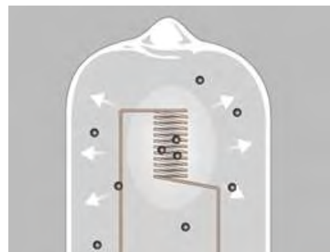
Figura 3.1.6. Las partículas de tungsteno negras fluyen del filamento incandescente hacia el extremo más frío de la cápsula.
