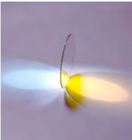
Figura 3.1.11. Filtro dicroico (de interferencia). Izquierda luz a filtrar, derecha, longitud de onda deseada.
