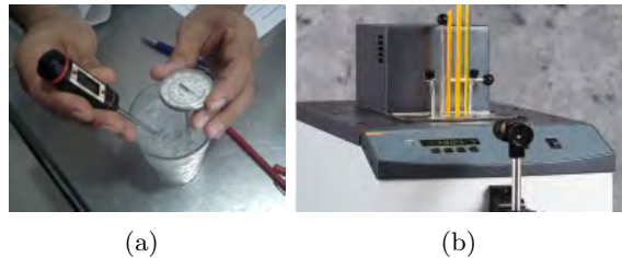
Figura 3.1. Procesos de calibración de termómetros, en (a) se tiene una calibración con un fenómeno físico como referencia y en (b) una calibración por medio de un equipo para calibración
