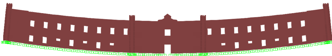
Fig. 4.4. Deformación del modelo debido a combinación de cargas con el patrón de hundimientos parabólicos
