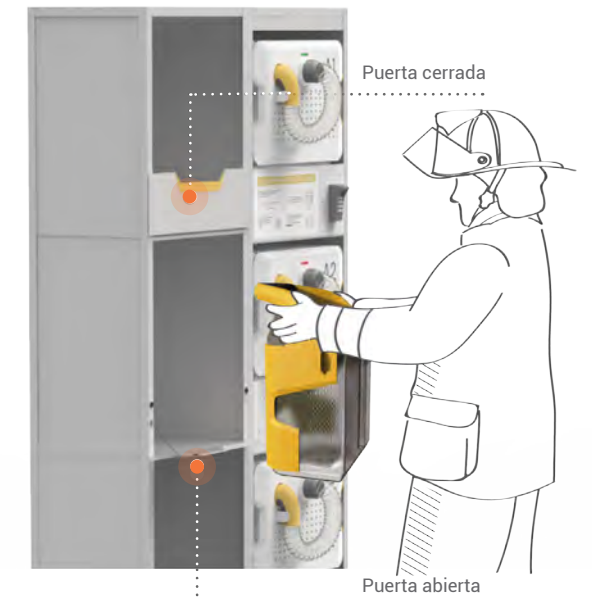
Bombero colocando el contenedor de abejas en el módulo.
