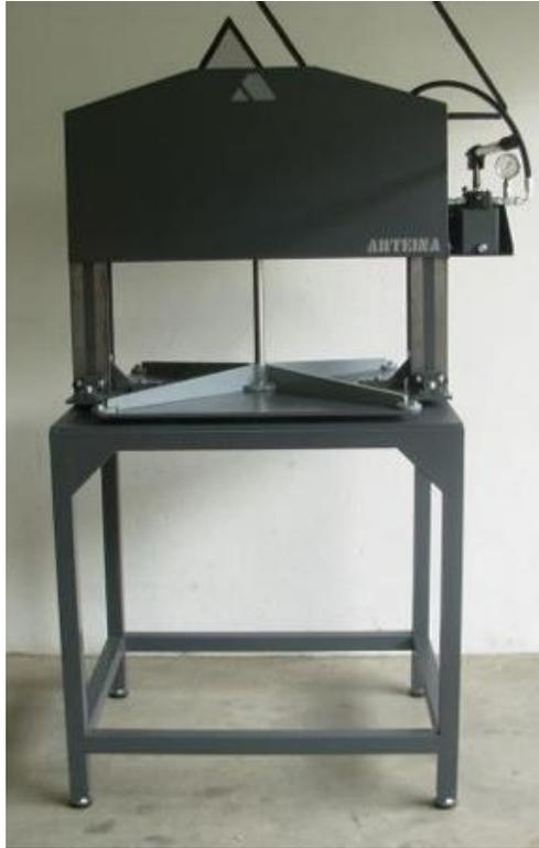
Figura 1-9.- Prensa vertical hidráulica (Arteina, 206)
