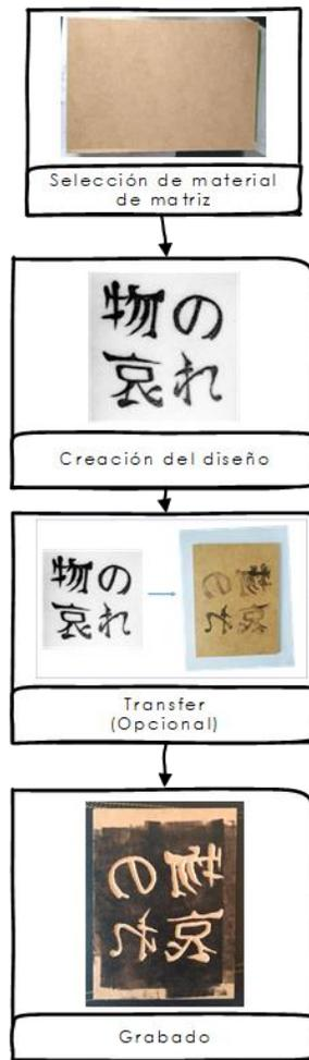
Figura 4-9 Proceso de fabricación de las matrices
