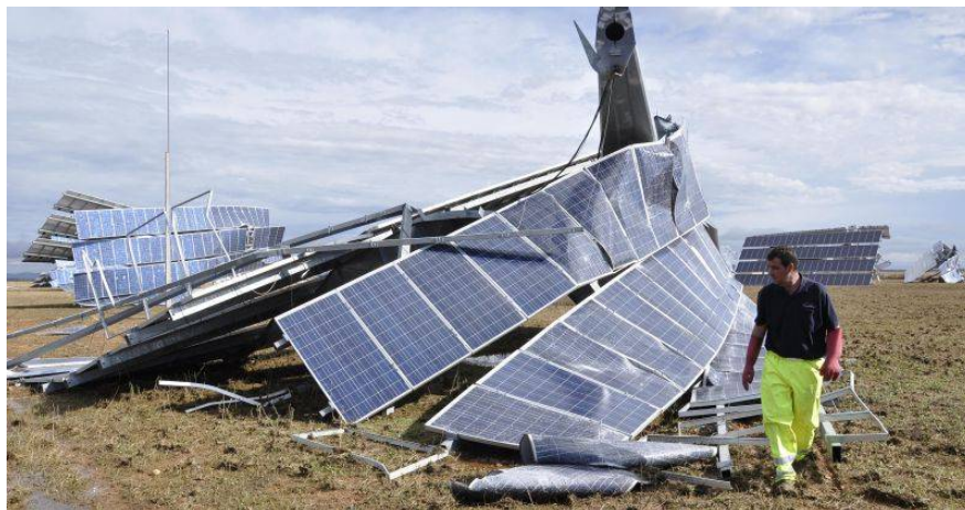
Figura 19. Seguidores solares destrozados por el tornado que azotó Sada con vientos de hasta 100 km/h. En “El tornado arrasó más de 6.000 hectáreas en las Cinco Villas”, por El periódico de Aragón, 2013. Recuperado de https://www.elperio-dicodearagon.com/noticias/temadia/tornado-arraso-mas-6-000-hectareas-cinco-villas_889288.html . Cortesía Gobierno de Aragón.
