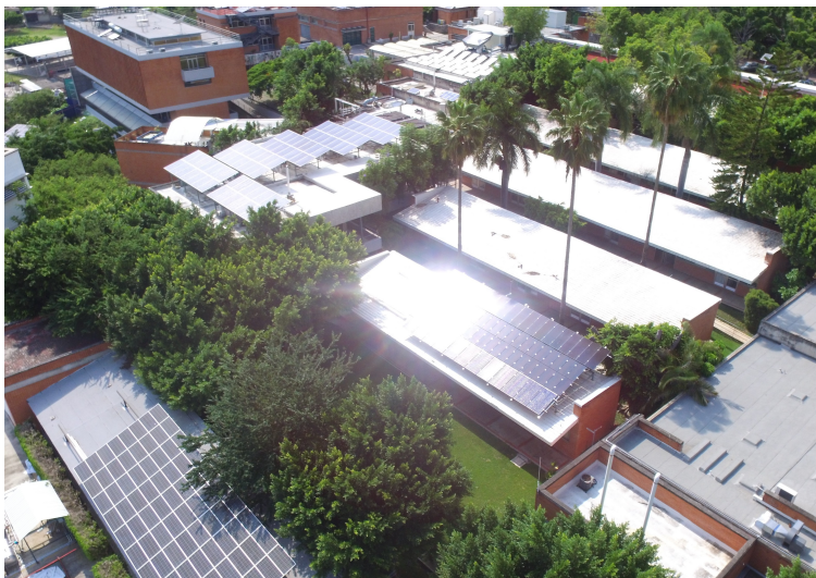
Figura 5. Deslumbramiento solar producido por módulos fotovoltaicos instalados en el Instituto de Energías Renovables (IER) a las 4:32 pm el día 4 de Julio de 2018.
