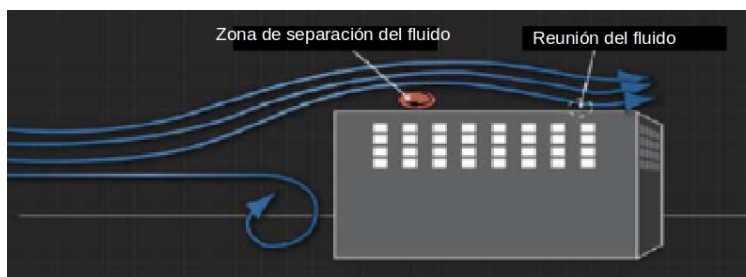
Figura 67. Flujo de separación y reinsertión en un edificio (Diagrama cortesía Cermak Peterka Petersen).
