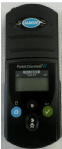
Figura 29 Equipo medición cloro Hach
