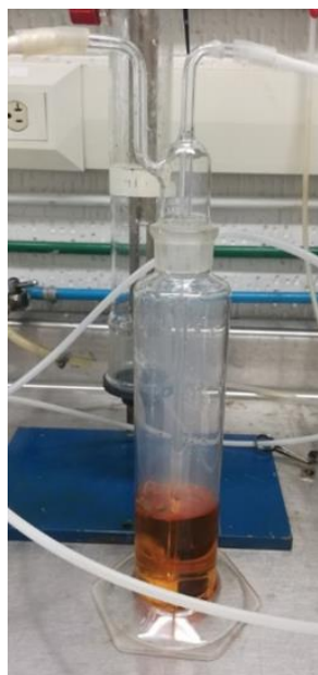
Figura 31 Lavador de gases
