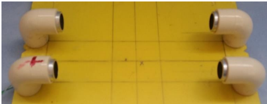
Figura 4. 37. Segundo diseño del anemómetro sónico.
