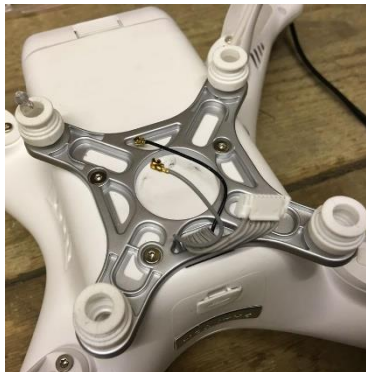
Figura 4. 27. Estructura donde el gimbal se acopla al Phantom 2.
