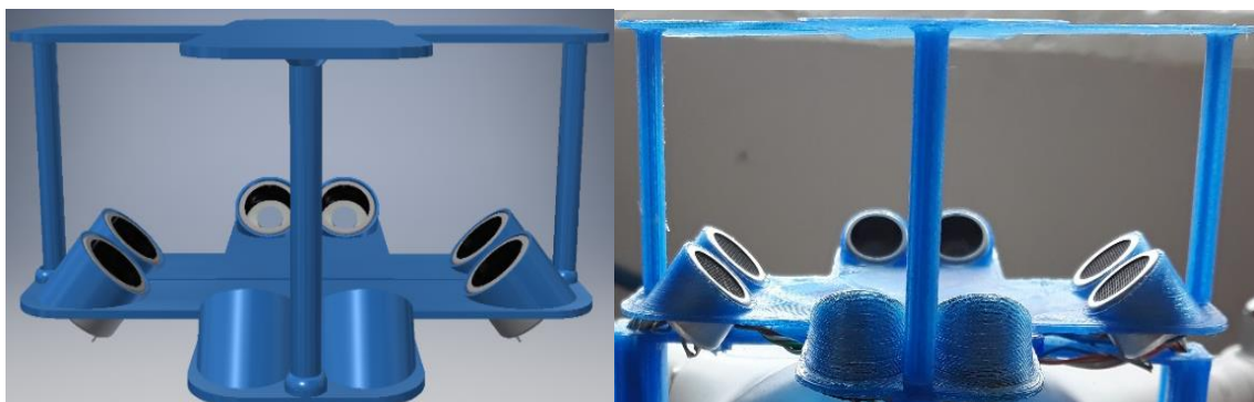
Figura 4. 40. Diseño (izquierda) e impresión 3D (derecha) del anemómetro sónico.
