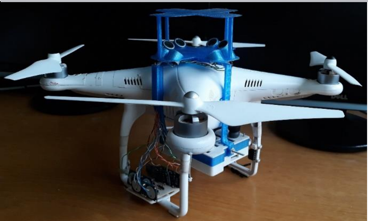
Figura 4. 43. Drone con la sonda meteorológica: diseño CAD (parte superior) e impresión 3D con sensores (parte inferior).
