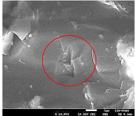
Figura 4.22 Detalle de poro de coque en bruto
