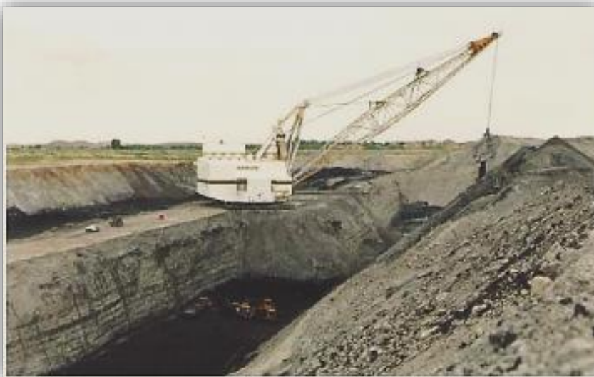
Figura 2.2 Explotación de carbón mediante el método de descapote de mantos con dragalina
