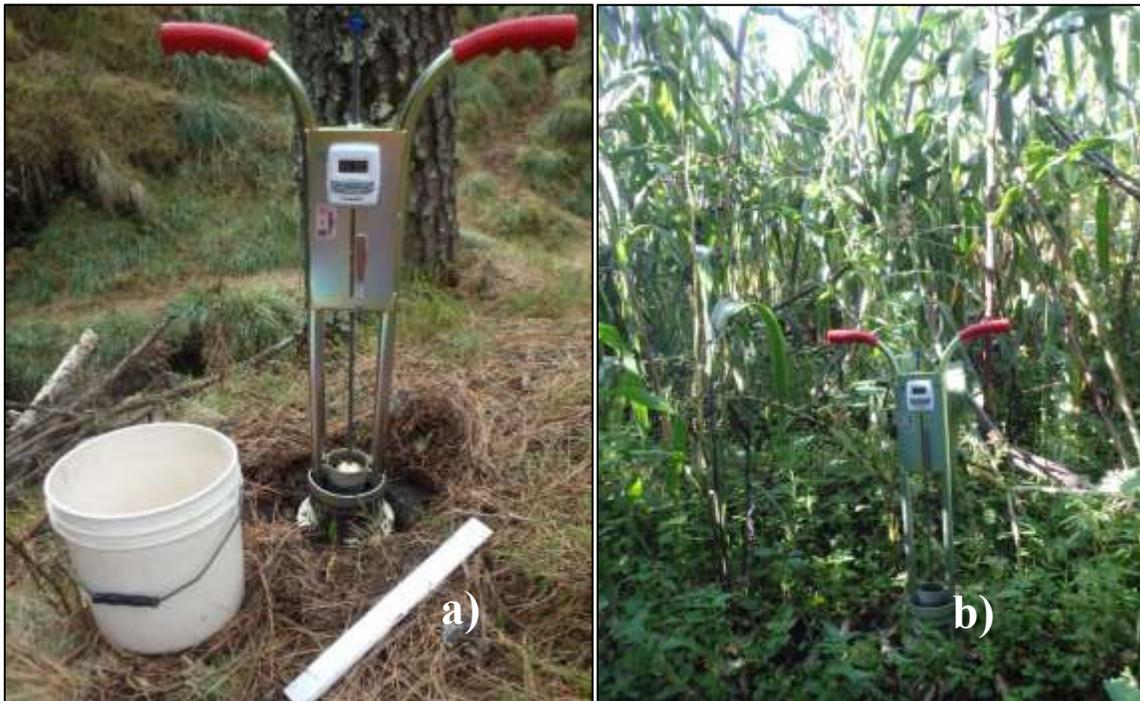
**FIGURA 11.** Medición del proceso de infiltración en dos sistemas vegetales diferentes; a) sistema forestal, b) parcela de cultivo.
