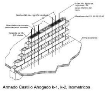
Armado Castillo Ahogado k-1, k-2, Isometricos
