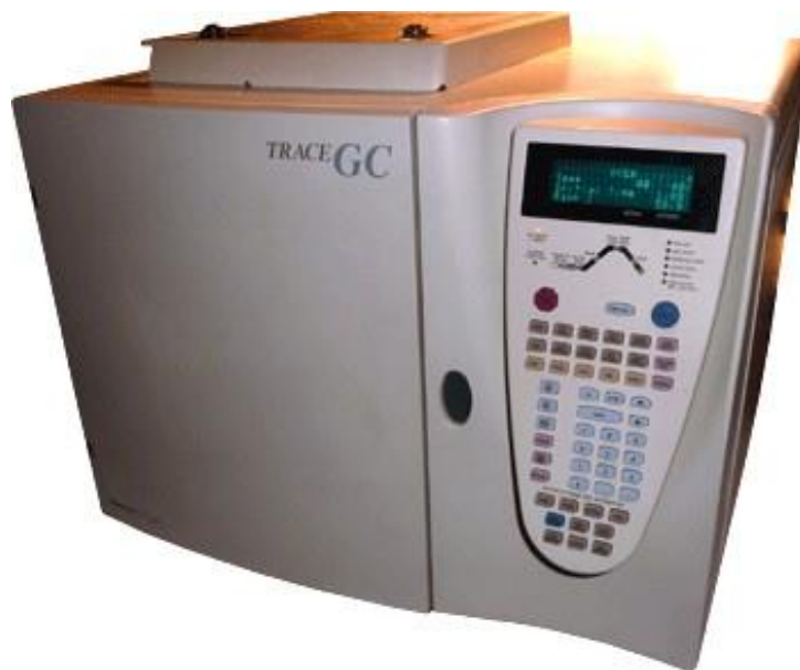
Figura 11 Cromatógrafo de gases. DIF= Detector de ionización de flama marca ThermoScientific.
