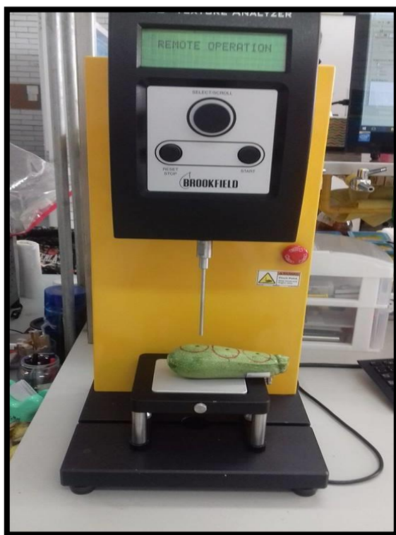
Figura 17. Medición de Textura con el Texture analyzer CT3 Brookfield.
