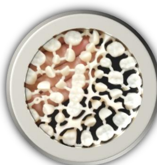
Fig.14 Equipo CAD-CAM. A) Escáner, sistema de diseño software y fresadora. B) Disco de zirconia. C) Disco con el fresado de varias prótesis. Fuente directa
