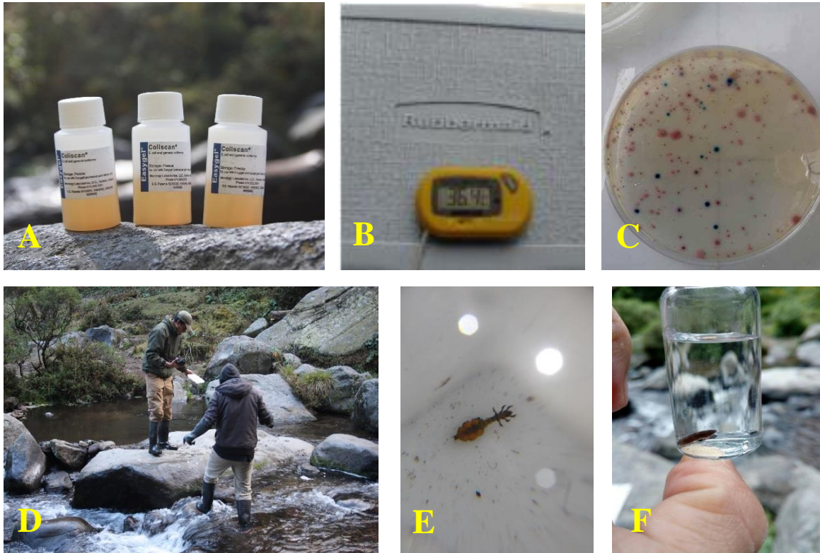
Figura 9. Análisis de bioindicadores en el río Magdalena, CDMX. A) Medio de cultivo Coliscan Easygel® con muestra de agua, B) Incubación de colonias a 36.4°C, C) Conteo de unidades formadoras de colonias (UFC), D) Búsqueda de macroinvertebrados en el lecho del río E) y F) Organismos en recipientes para su identificación. Fuente: Trabajo de campo 2017.
