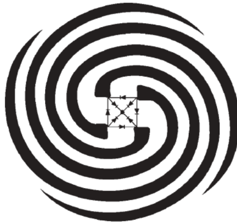
Figura 1:26: Desplazador de fase de 2 bits basado en un arreglo reflectivo tipo espirafase [22].
