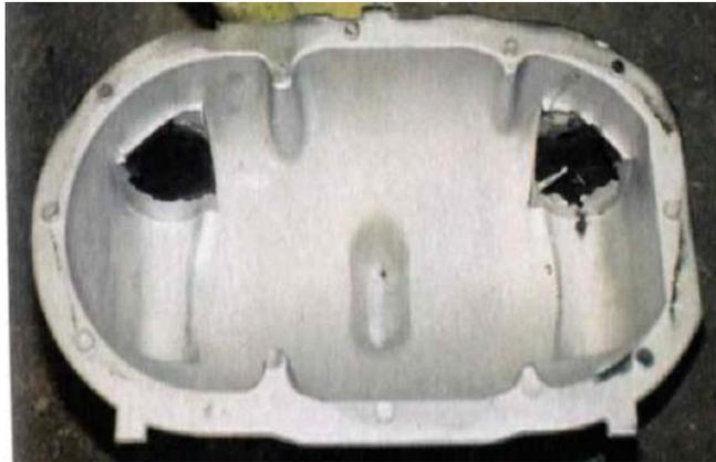
*Figura 1.2 Parte defectuosa debido a una baja temperatura de vaciado del metal*
