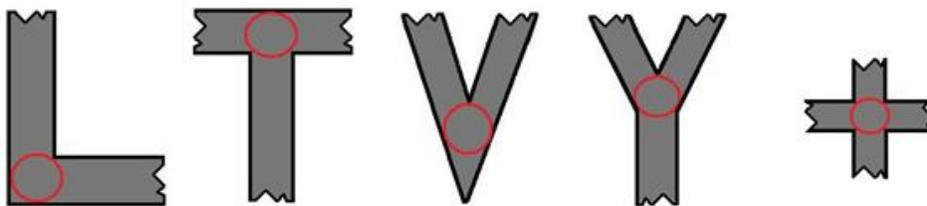
**Figura 1.13** Ejemplo de uniones en piezas de fundición.
