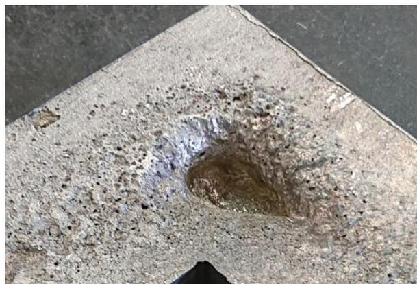
**Figura 4.13** Rechupe pieza en "L" (Vista superior)
