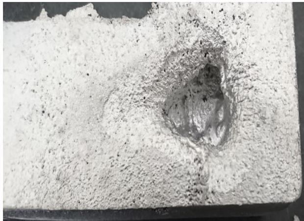
**Figura 4.2** Rechupe pieza en “L” (Vista superior)
