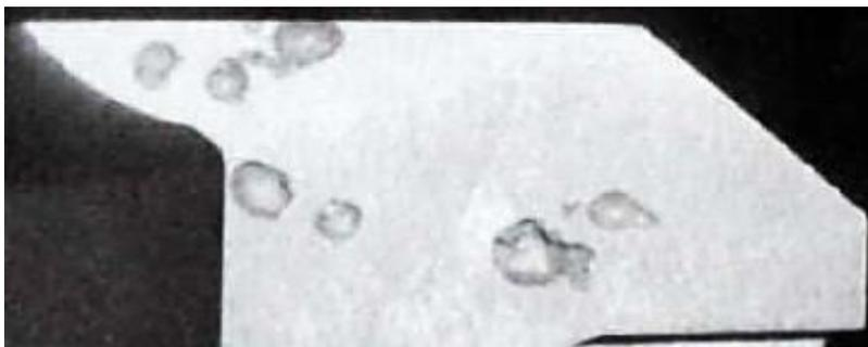
**Figura 1.1** Defecto por gas atrapado (sopladura), corte transversal en una pieza de aluminio.
