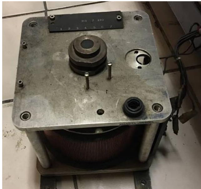
Imagen 18. Variac de control de voltaje de la lámpara desconectado y sin motor.
