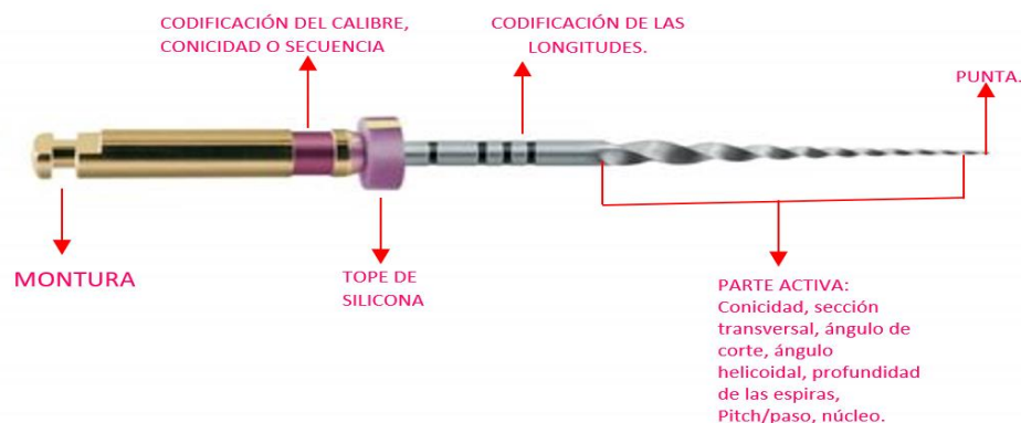
Figura 7 Esquema de componentes de lima rotatoria.
