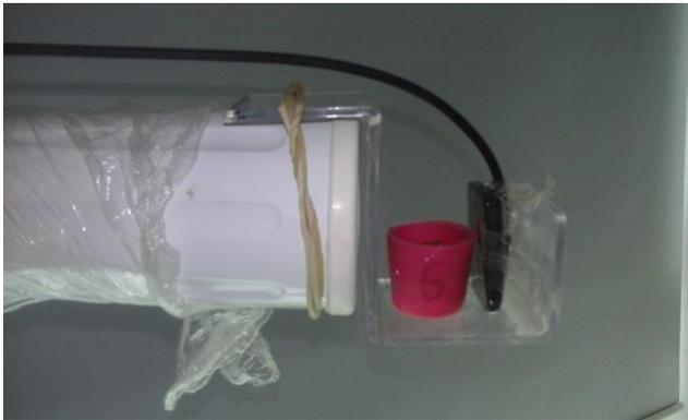
**Fig.1** Se toma radiografía inicial con ayuda de un colimador creado con plástico duro.
