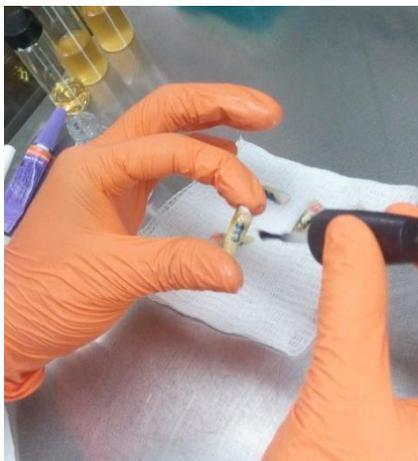
**JFig.10 Colocación de barniz de uñas para sellado de foraminas y conductos accesorios.**
