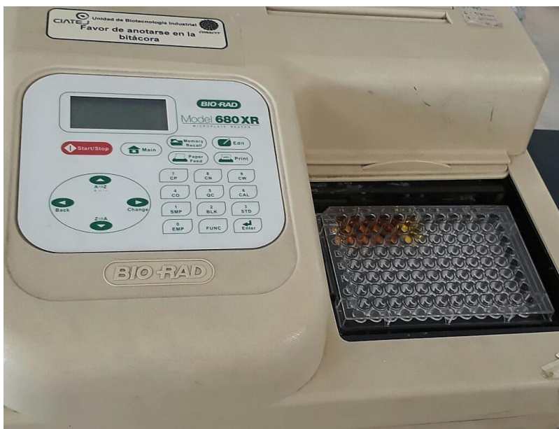
FIGURA 3. 6 ESPECTROFOTÓMETRO BIO-RAD LECTURA DE MICROPLACA CON MUESTRA Y REACCIÓN DNS. FUENTE: YARITZA LÓPEZ, CIATEJ ZAPOPAN.
