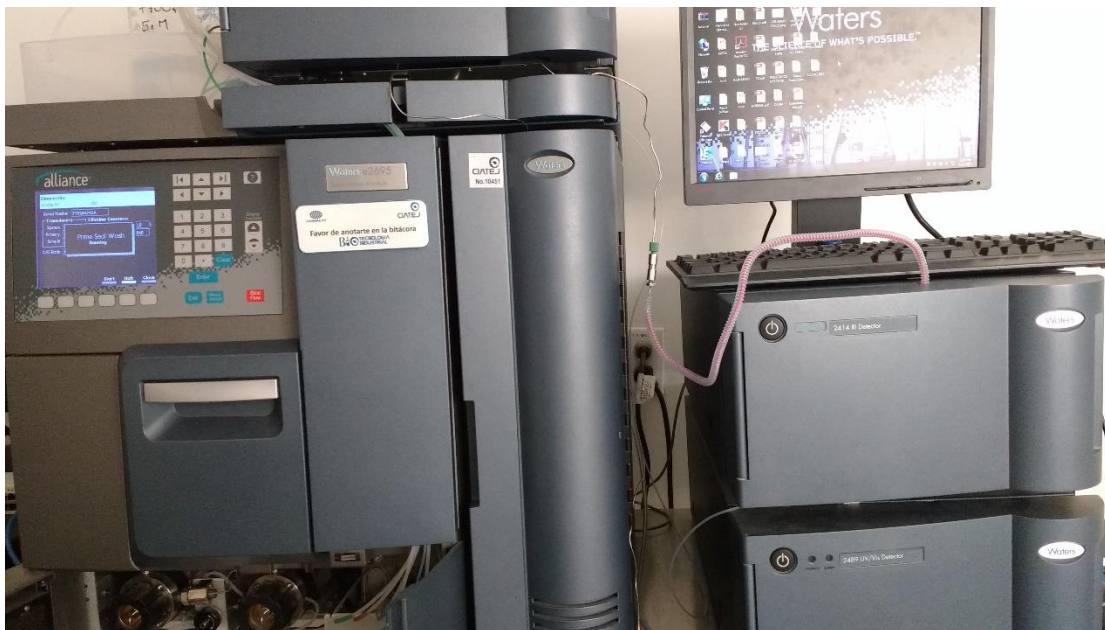
FIGURA 3. 9 CROMATÓGRAFO LÍQUIDO DE ALTA RESOLUCIÓN WATERS E2695, CIATEJ ZAPOPAN. FUENTE PROPIA
