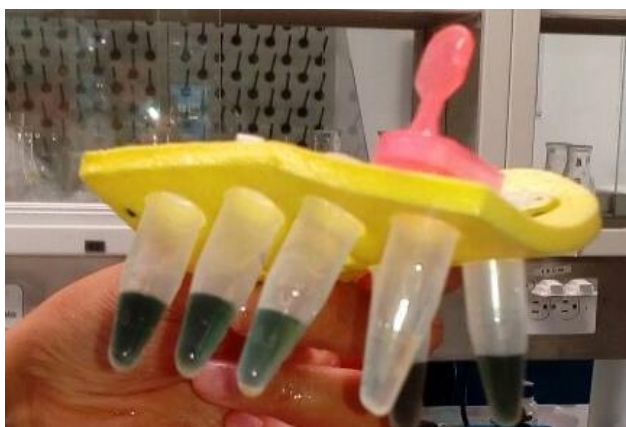
FIGURA 4. 9 MUESTRAS DE JUGO CRUDO DE AGAVE SOMETIDAS A LA REACCIÓN DE FEHLING.
