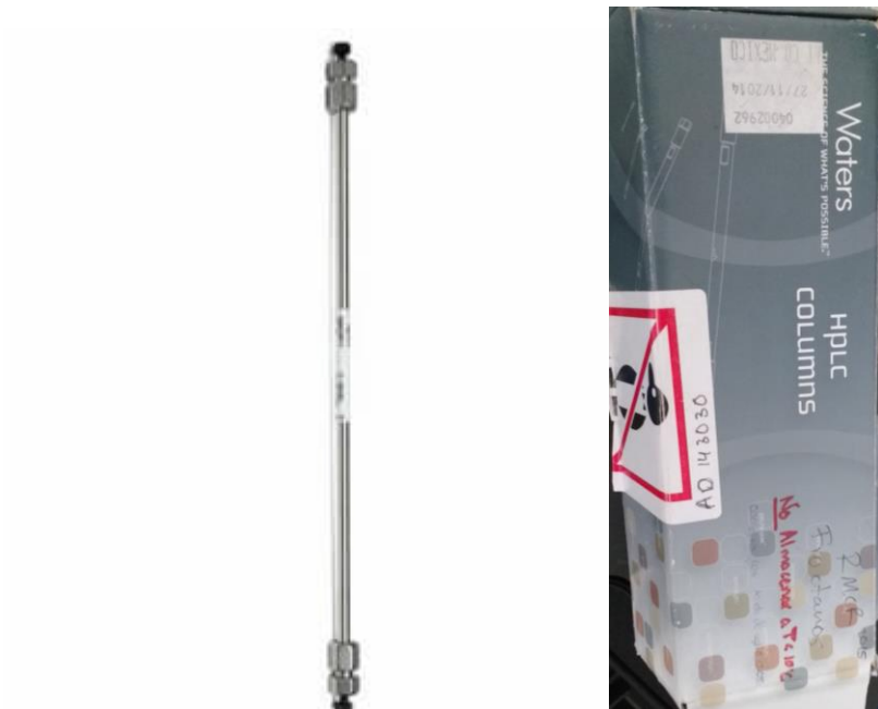
FIGURA 2. 11 COLUMNA ULTRAHYDROGEL DE CROMATOGRFÍA DE EXCLUSIÓN MARCA WATERS. FUENTE PROPIA, CIATEJ ZAPOPAN.
