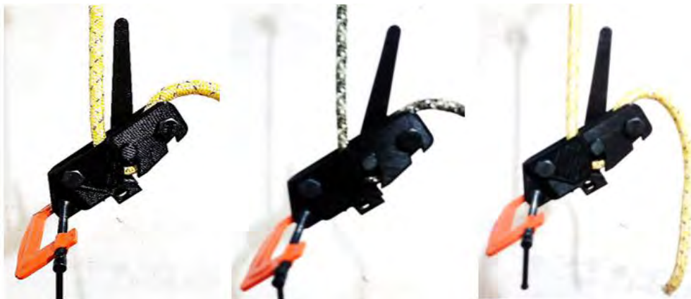
Figura 5.3 Pruebas de funcionamiento en posición de descenso
