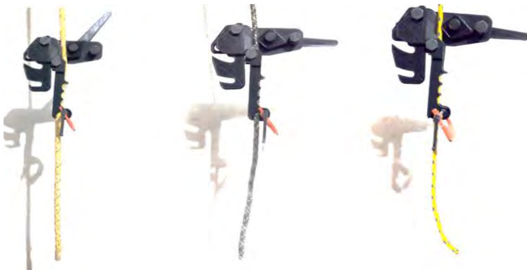
Figura 5.12 Prueba 2 de funcionamiento en posición de ascenso
