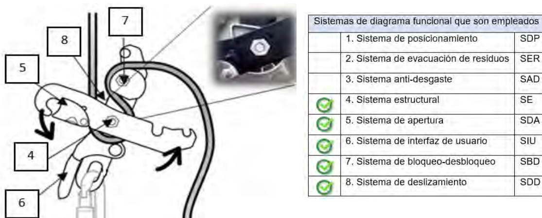
Figura 2.31 Identificación de sistemas descendedor stop
