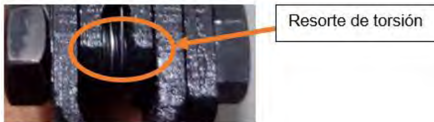
Figura 5.5 Sistema de posicionamiento
