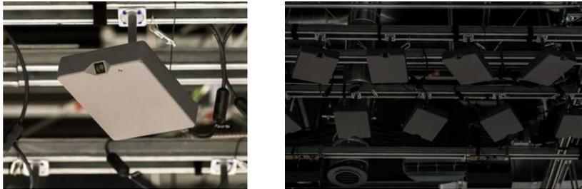
Figura 49. Cámaras de visión utilizadas por Amazon Go®
