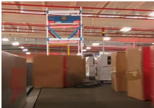
*Figura 45. Cajas desviadas mediante “shoe sorters”*
