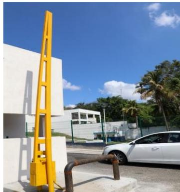
*Figura 3. Levantamiento de la pluma de estacionamiento (forma manual)*
