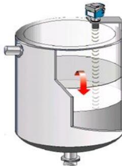
*Figura 21.* Ejemplo de medidor por ultrasonido
