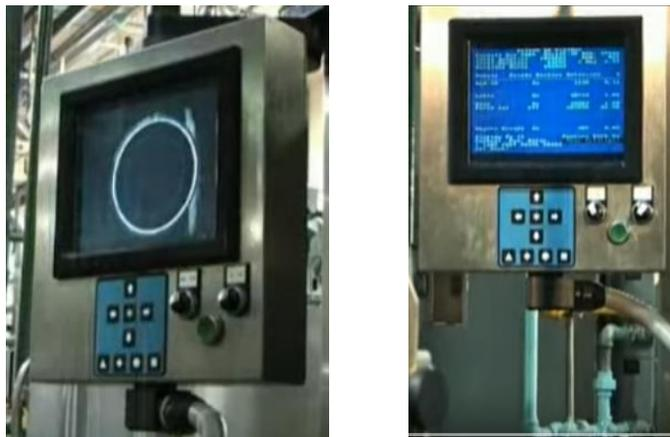
Figura 40. Cámara digital inspecciona cada botella
