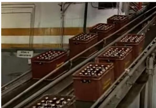
*Figura 42.* Empacadora automática y cajas contenedoras que se dirigen al paletizado o completar los faltantes
