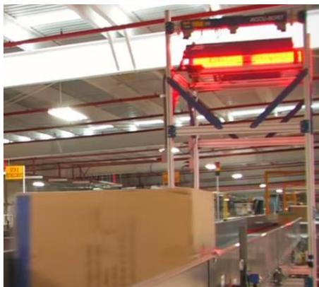
*Figura 44.* Lector de códigos de barra de la banda transportadora
