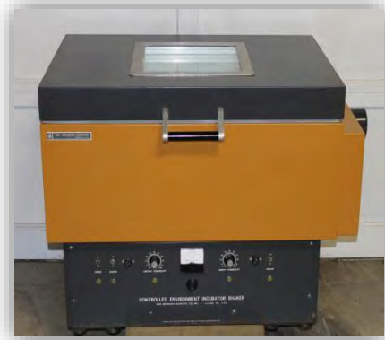
Figura 14. Incubadora con agitación (New Brunswick scientific co 625).
