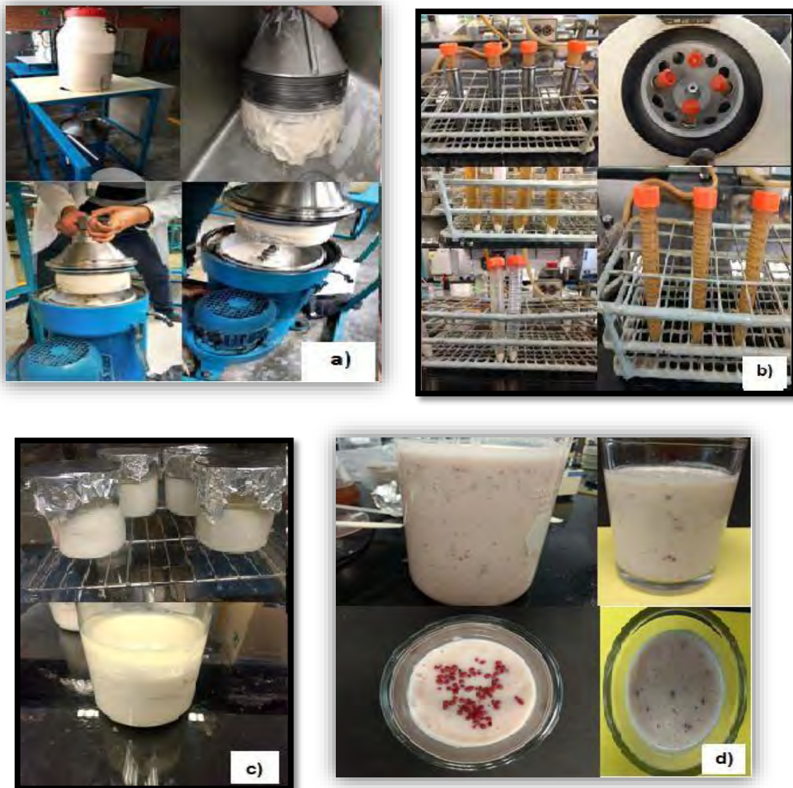
Figura 20. Elaboración del yogurt bajo en grasa adicionado con CLA encapsulado, a) desgrasado de la leche, b) inoculación c) incubación, fermentación de la leche, d) yogurt producto final.
