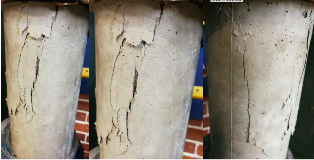
Fallas en cilindros con 0.5% de fibra grande
