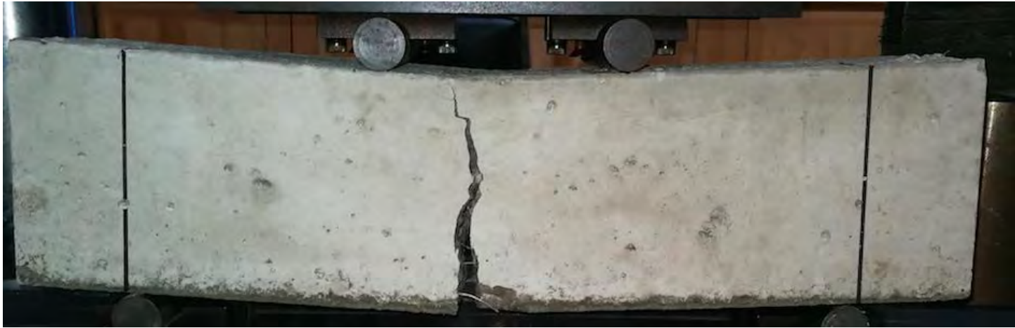
Falla en viga con 0.5% de fibra grande
