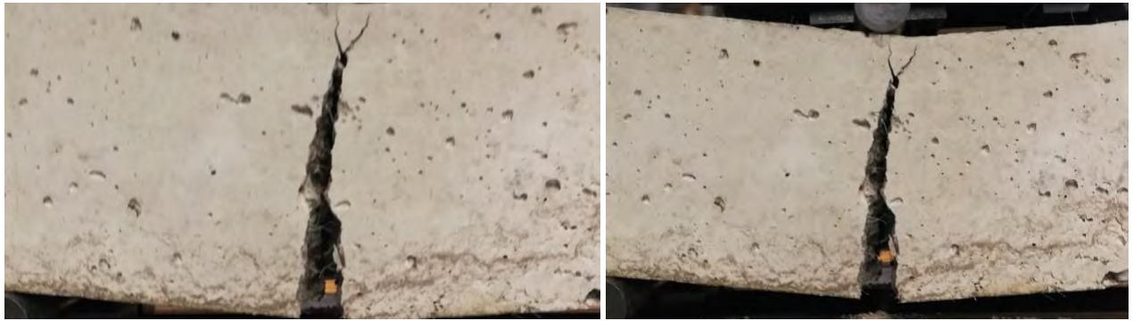
Falla en vigas con 0.5% de fibra chica
