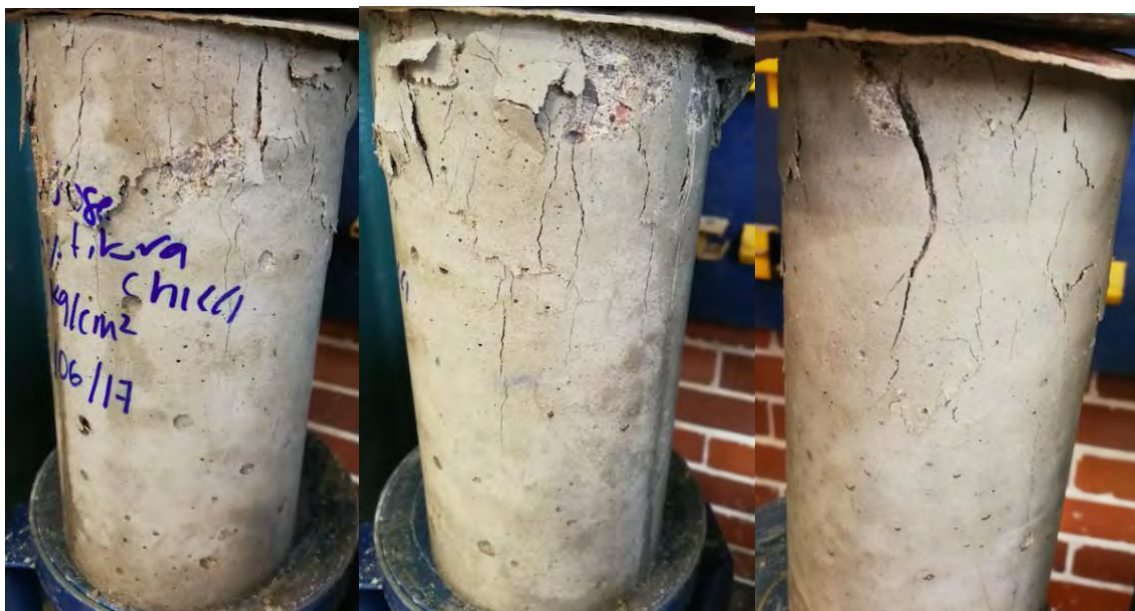
Fallas en cilindros con 2% de fibra chic
