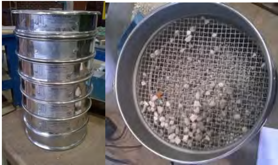
MALLAS O CRIBAS POR LAS CUALES SE VIBRAN LOS AGREGADOS FINOS. FOTO DE AUTOR
