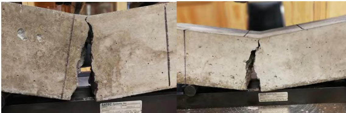
Falla en vigas testigo
