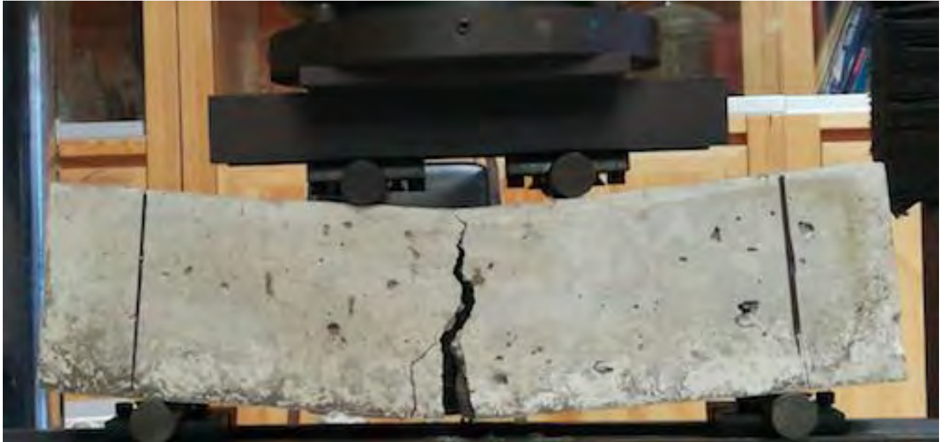
Falla en viga con 0.5% de fibra grande
