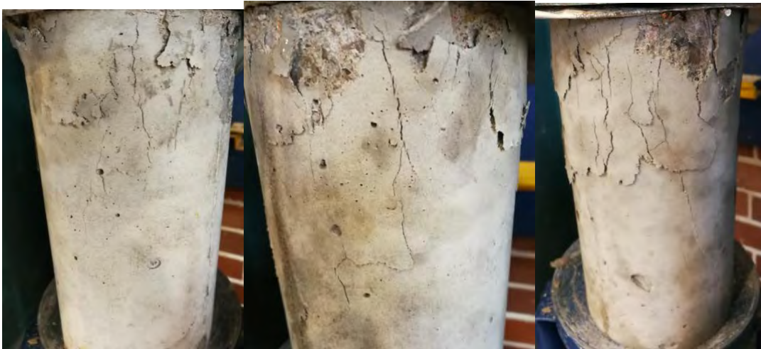
Falla en cilindros con 2% de fibra grande
