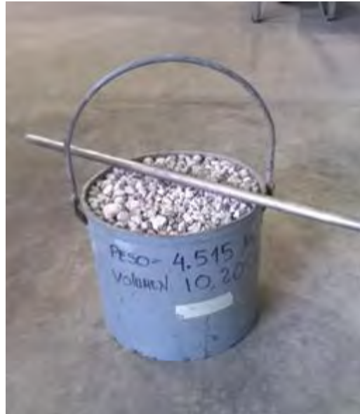
CUBETA PARA OBTENER EL PESO VOLUMÉTRICO. FOTO DE AUTOR
