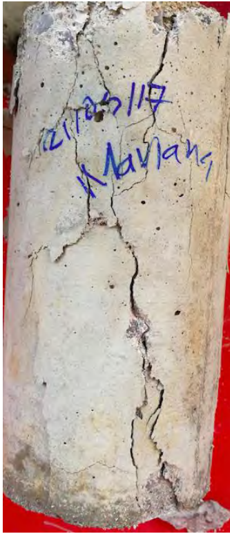
Falla en cilindro testigo
