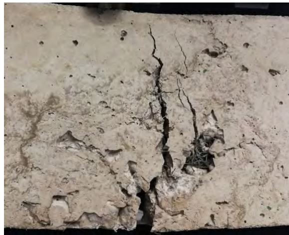
Falla en vigas con 0.5% de fibra chica
