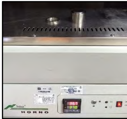
Figura 3. Molde de prueba y anillo en acondicionamiento en cámara ambientadora en seco. Fuente directa.
