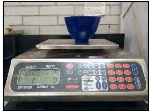
Figura 14. Pesaje del yeso en polvo en balanza analítica Fuente directa.
