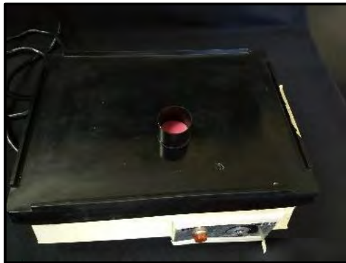
Figura 13. Molde cilíndrico de plástico con la muestra del material para impresión. Fuente directa.
