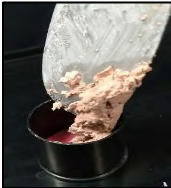
Figura 19. Transferencia de la mezcla en el molde de plástico. Fuente directa.
