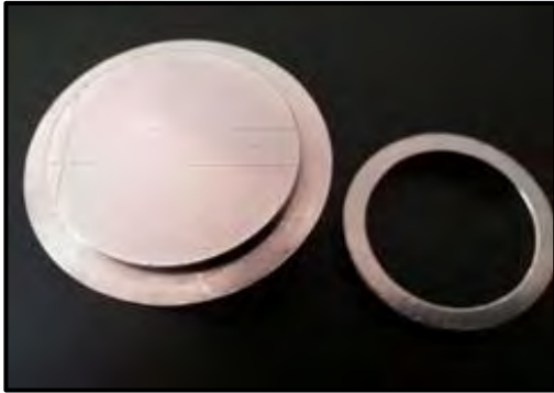
Figura 6. Molde de prueba y anillo acondicionado. Fuente directa.
