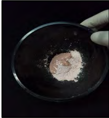
Figura 17. Humectación del yeso. Fuente directa.
