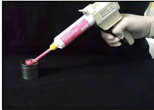
Figura 7. Introducción del material de impresión en el molde de prueba. Fuente directa.
