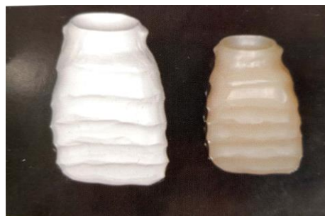
Figura 33 Variación volumétrica del 25 % entre zirconio presinterizado y sinterizado. 20
