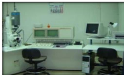
Figura 23. Microscopio electrónico de barrido.
