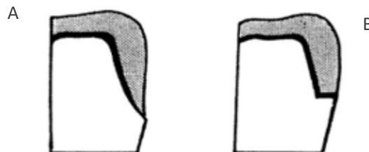
Figura 10. A) Terminación junta deslizante. B) terminación junta tope.<sup>24</sup>
