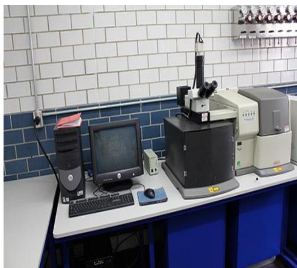
Figura 33 Espectrómetro Raman dispersivo, Almega XR Thermo-Nicolet del laboratorio universitario de caracterización espectroscópica (LUCE/ICAT-UNAM).
