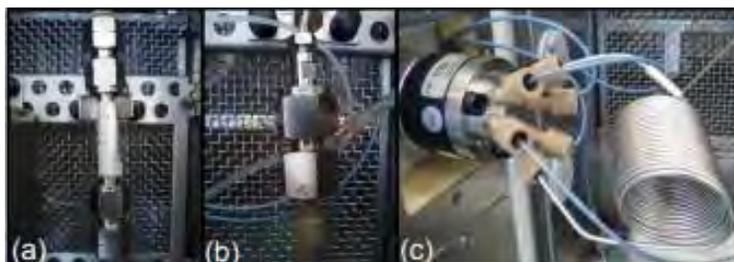
Figura 11. (a) Columna TOSOH DAEA-5PW; (b) precolumna TOSOH DAEA-5PW; (c) bucle de 1 mL. Tomado de Rivera, 2017.
