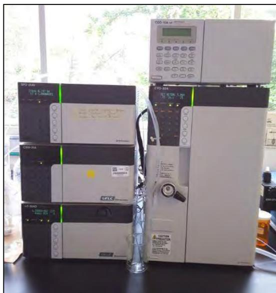
Figura 10. Cromatógrafo SHIMADZU SPD-20AV.
