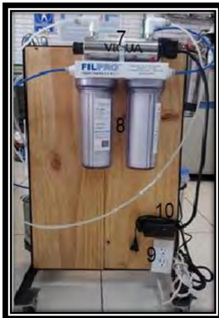
Figura 10. Parte trasera del reactor UV-C: 7) Reactor UV-C 8) Filtros de carbón activado 9) Fuente de luz 10) Conexión a reactor y bomba.
