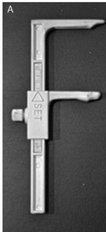
Fig. 13 Craneómetro de Knebelman por su lado SET, con sus brazos, el superior fijo y el inferior móvil, con el tornillo de fijación.
