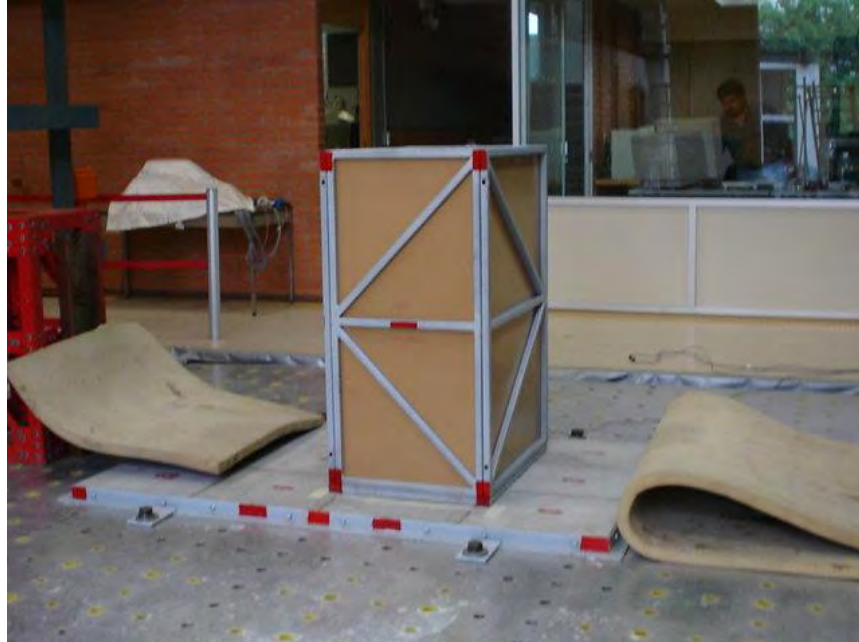
Figura 2.4 Mesa vibradora con prototipo P5 instalado.
