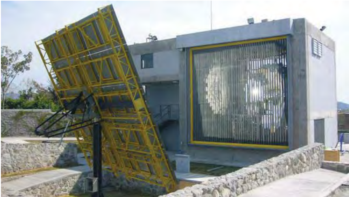
Figura 4.14. HoSIER, de la UNAM-Conacyt donde se realizó el experimento de fatiga foto-termo-mecánica para probetas cilíndricas tubulares de acero inoxidable AISI 316.
