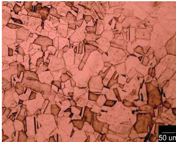
Figura 5.2. Micrografía del acero inoxidable AISI 316 en estado de post-producción , 200 x
