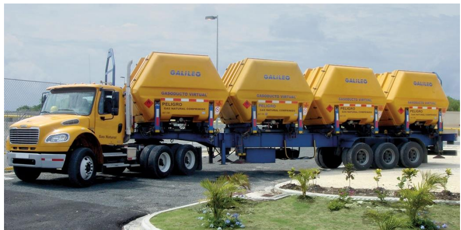
Figura 5.13 Contenedor Mat Gas Natural Comprimido, (Galileo)
