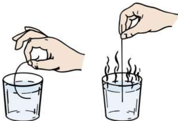
Fig. 25. Ejemplo memoria de forma en un clip.
