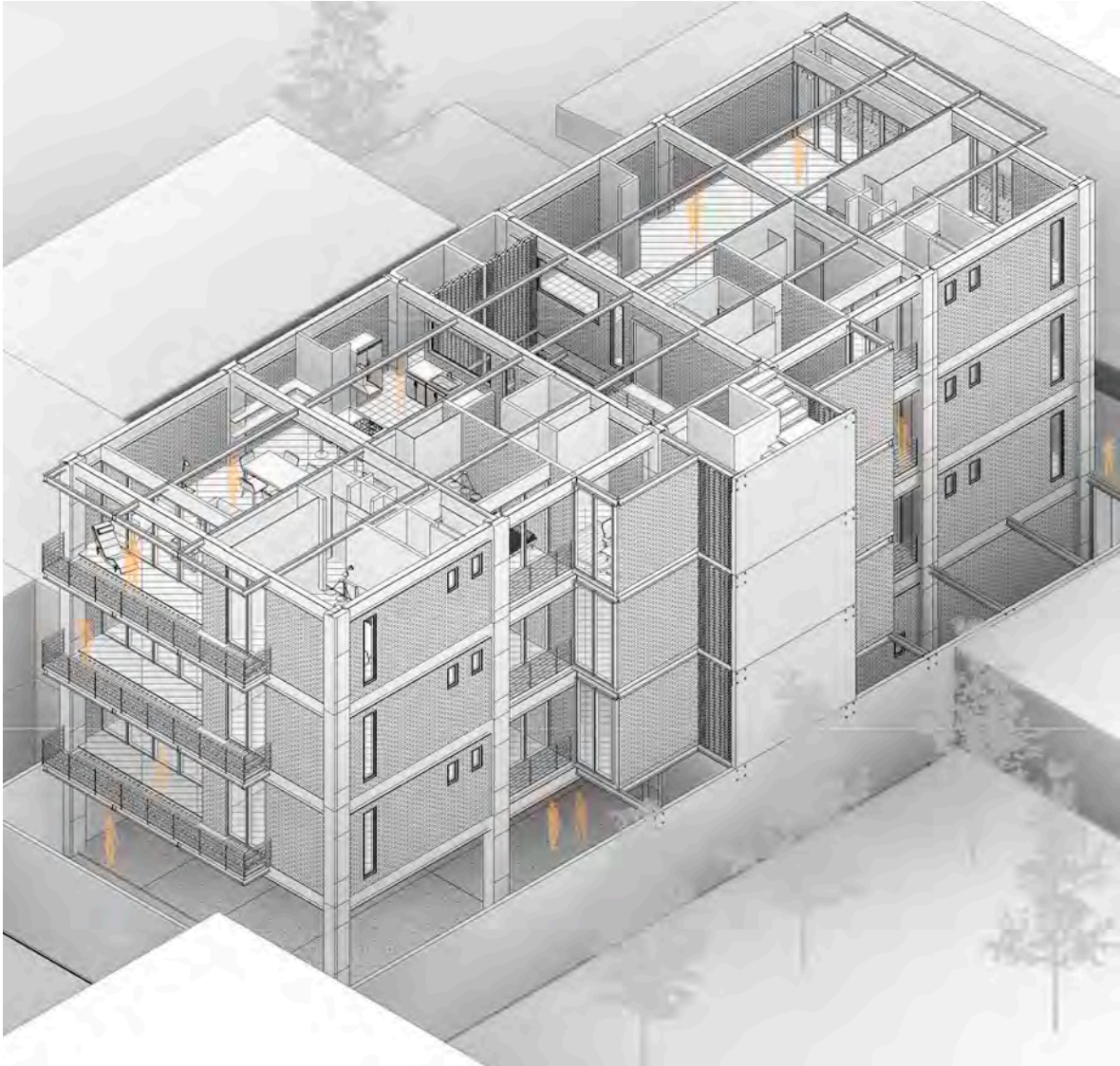
ESTRUCTURA TERMINADA CON PÁNELES INTERIORES Y MUROS DE MAPOSTERÍA EN FACHADAS
