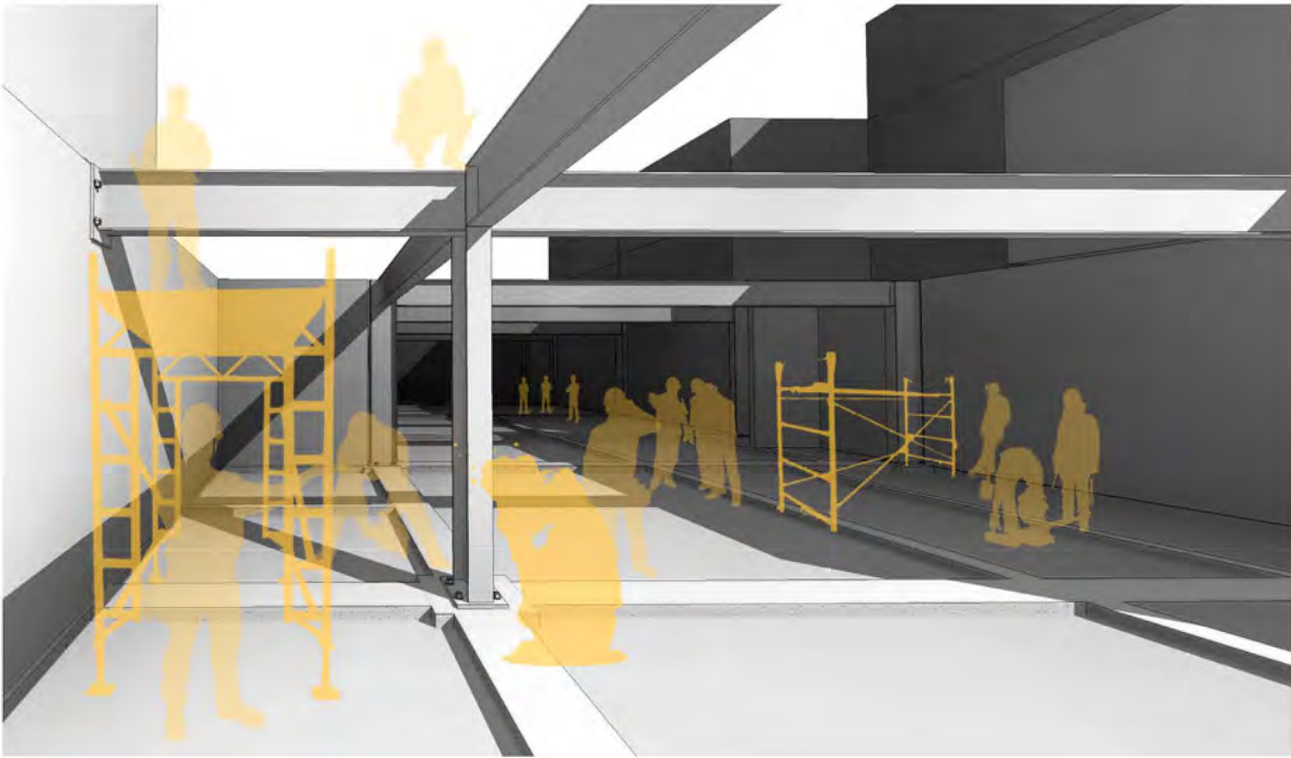
ANCLAJE DE VIGAS PARA CONFORMAR PORTICOS DE ACERO, ANCLAJE A MURO COLINDANTE POR MEDIO DE PLACA SOLDADA A ARMADO PREVIO A COLADO DE MURO.
