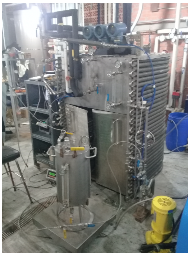
Figura 4.18: Carga de la mezcla NH_3 - LiNO al equipo de absorción.
