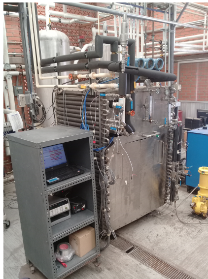
Figura 4.16: Sistema de absorción con conexión a bomba de pistones y sistema de adquisición de datos.
