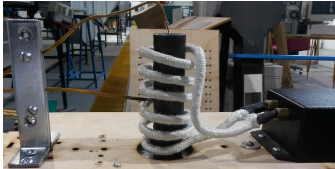
Figura 3.25. Sujeción de termopares por medio de perfiles en “L”.
