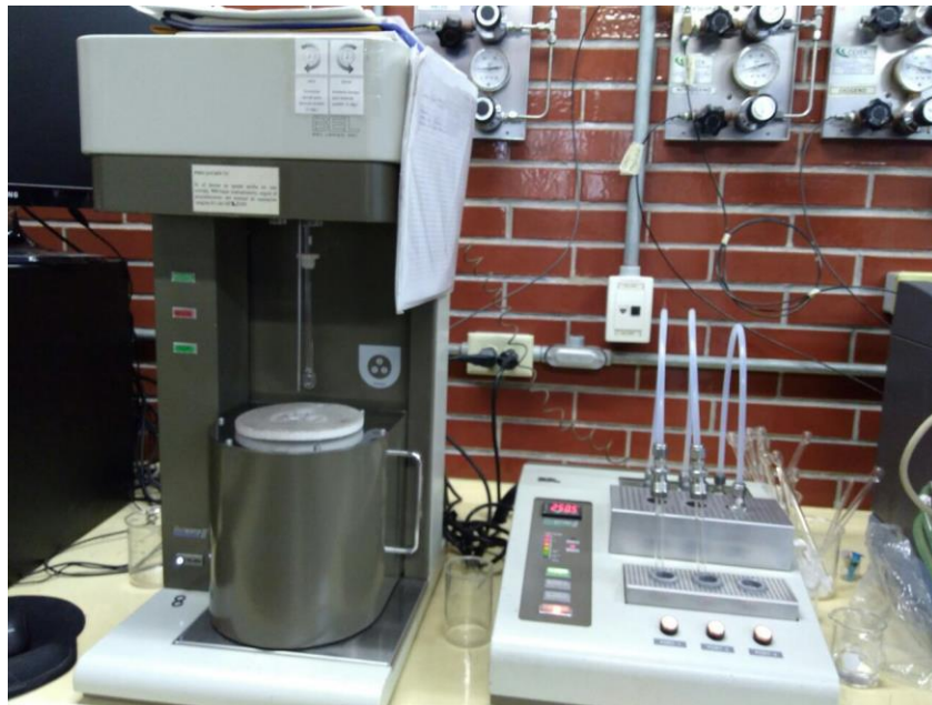
Fig. 3.13. Del lado izquierdo se observa la máquina modelo MINISORP II de la marca BEL-Japan. Del lado derecho se tiene la máquina que se utilizó para desgasificar a las muestras utilizando una presión de 10 -5 bares por un tiempo de 24 h.
