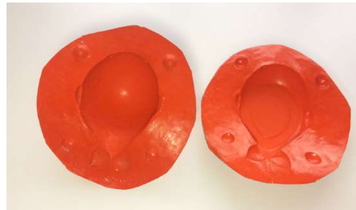
Figura 66. Foto del molde para prototipo funcional.
