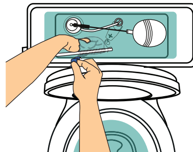
5. Asegurar el sujetador en la pared del tanque.
