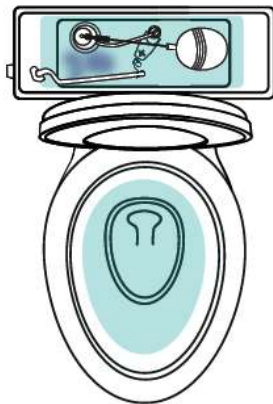
Figura 18. Esquema de funcionamiento de revelación de fugas. Fuente: Elaboración por autoras.
