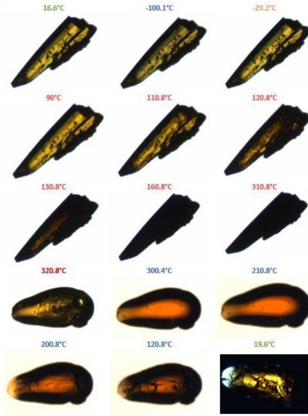
**Figura 44.** Imágenes de microscopio tomadas en la platina de calentamiento a temperatura variable para el cocristal.
