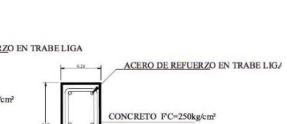
TRABE LIGA TL-5 SECCION 0.20 X 0.42 X 1.50 mts
