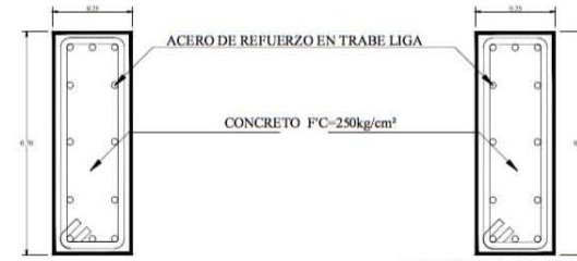
TRABE LIGA TL-5 SECCION 0.25 X 0.70 X 9.45 mts
