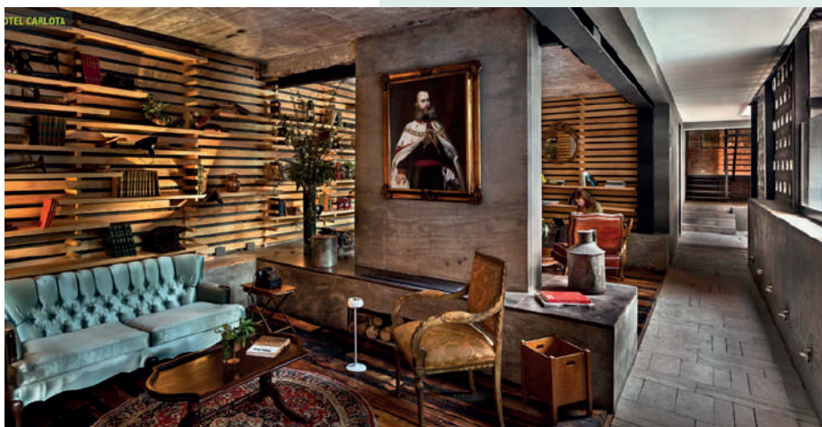
IMG. 10 USO DE CONCRETO CON ACABADO APARENTE EN MOBILIARIO, PISOS Y MUROS, ASI COMO DETALLES DE MOBILIARIO EN MADERA.
