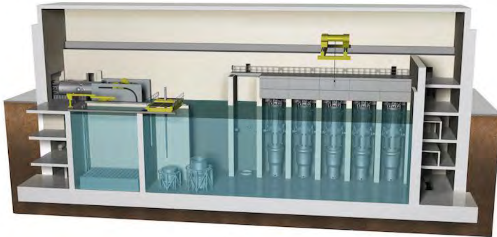
Figura 1. Diseño general de la sala de reactores y de recarga de NuScale.
