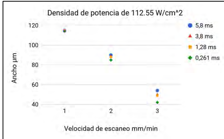
Figura 3.29: Gráfica que muestra el ancho Vs velocidad de escaneo a una densidad de potencia de 112.55 W/cm^2 con diferentes tiempos de pulso.
