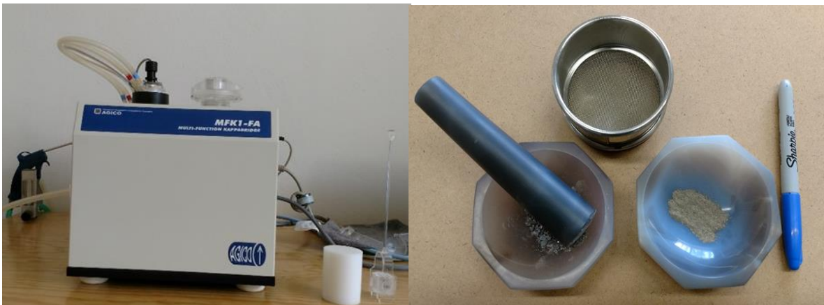
Figura 5.6. Susceptibilímetro marca AGICO modelo MFK1 y detalle de la muestra utilizada por sitio para la determinación de la temperatura de Curie.
