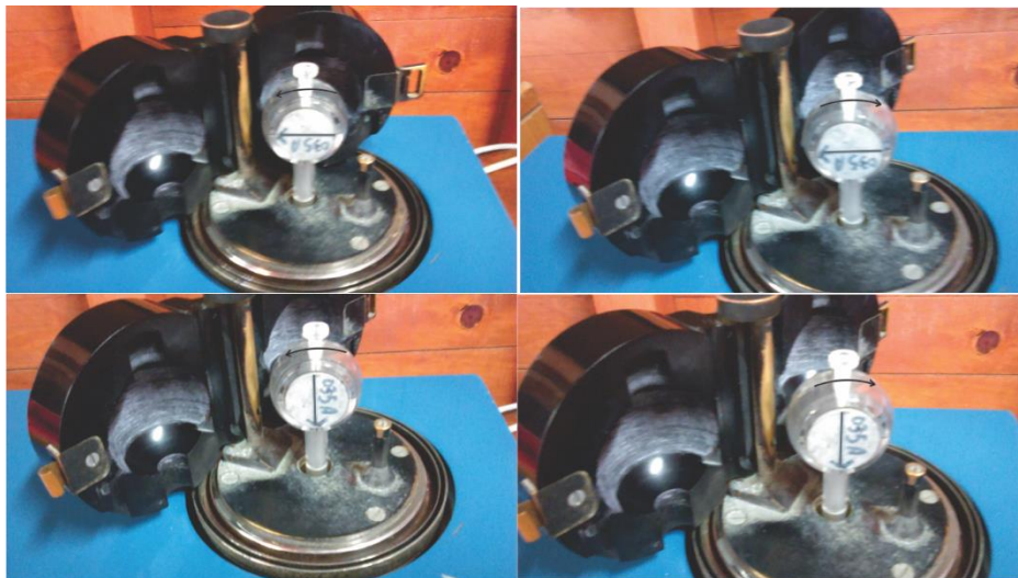
Figura 5.3. Colocación de las muestras en las cuatro posiciones para medir la MRN, la flecha en la muestra indica la marca de orientación magnética al momento de la recolección en campo.
