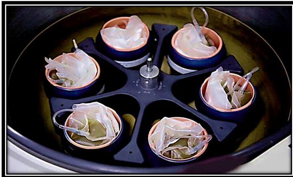
Imagen 69. Acomodo correcto de las bolsas de sangre en la centrifuga. Extraída de: https://bit.ly/2lykNG8 .
