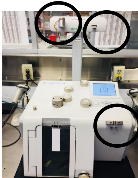
Imagen 115. Calibración del fraccionador de bolsas de sangre total. Se observa en la imagen tres círculos donde se debe de poner la pesa. Hospital Infantil de México Federico Gómez.
