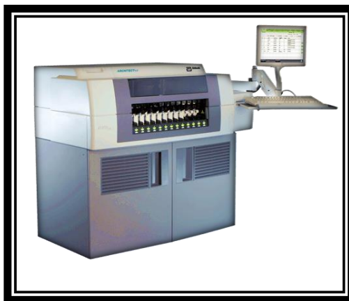
Imagen 112. Equipo utilizado en serología. Architect i1000SR. (Abbott).
