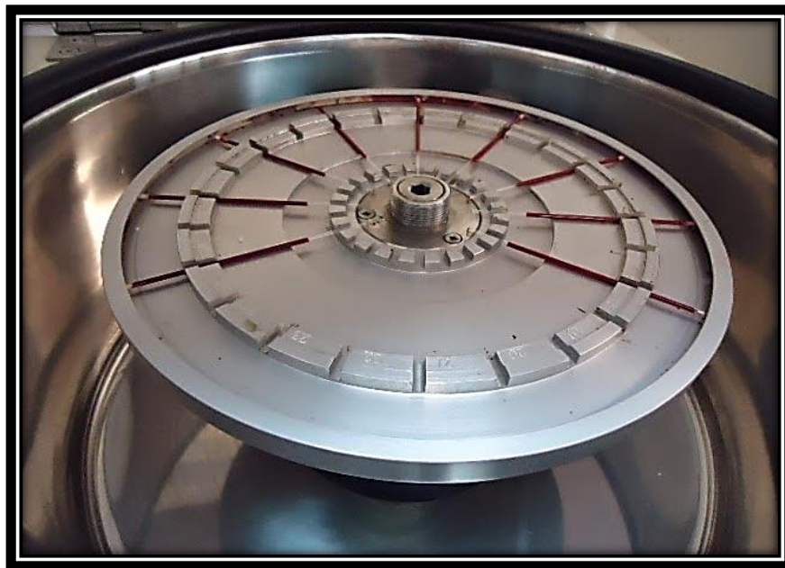
Imagen 25. Microcentrifuga. Los tubos capilares se colocan frente a frente con la finalidad de poder balancear el rotor. Extraída de: https://bit.ly/2rQtvx .
