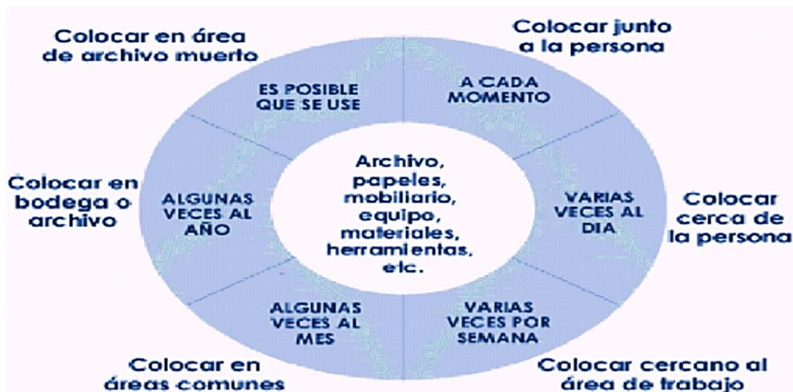
Figura 5. Localización de Objetos por frecuencia de uso. Cruz , 2008. Manual de Implementación del programa 5's.
