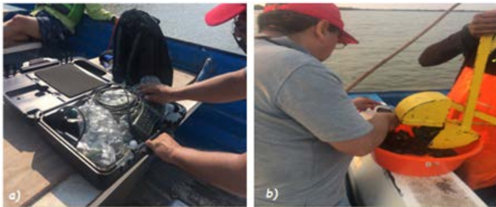
Figura 10.- Toma de muestras de Aguas y Sedimentos a) Sonda multiparamétrica HANNA HI 9829 b) Extracción y recolección de sedimentos mediante draga Van-Veen
