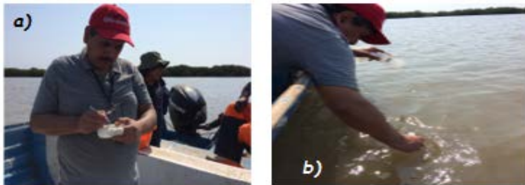
Figura 9.- Sitios determinados para el muestreo en la laguna de Tóbari a) Etiquetas y preservación de las muestras se clasifica y anota la información de las muestras tomadas de agua b) Filtración de muestras y obtención de las muestras de agua en diversos puntos de la laguna
